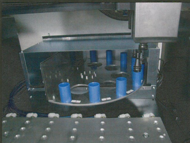
ロータリー式ATC (オプション) 最大11本(集塵ブラシ装着時は9本)の自動工具交換が可能。 テーブル奥へセットすることでXストローク500mmを実現。
