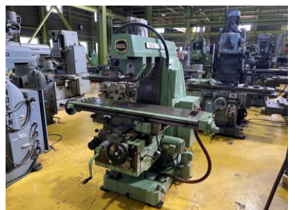
横フライス 平岡工業 2MF-P 1990年製 NT50
