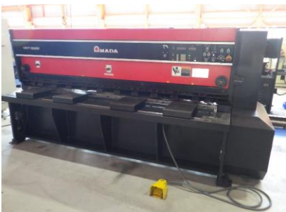
シャーリング アマダ DCT-2565 1990年製 6.5×2500 オートバックゲージ 管理番号:H016989 置場:マシンプラザ本庄
