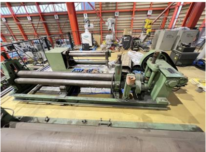
三本ロール 河合製作所 ロール径:160mm 幅2050mm 管理番号:P008028 置場:東日本マシンプラザ
