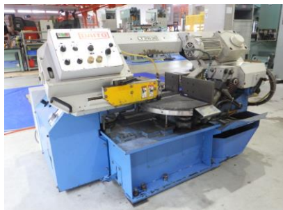
バンドソー 大東精機 LT2630 2005年製 帯鋸刃寸法27×0.9×3505mm 管理番号:H017350 置場:マシンプラザ本庄
