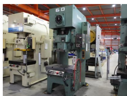
C型プレス アマダワシ PUX60AD 1998年製 60t ダイクッション付 管理番号:H017278 置場:マシンプラザ本庄
