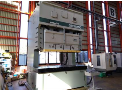
C型プレス コマツ OBW250-3B 1998年製 250t 管理番号:P007792 置場:東日本マシンプラザ
