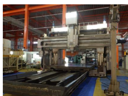
五面加工機 オークマ MCR-B II 35x50 2004.7年製 OSP-E100M BBT50 管理番号:H015701 置場:マシンブラザ本庄
