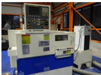
櫛刃型NC旋盤 西部電機
