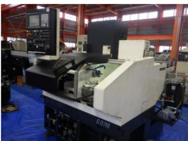
櫛刃型NC旋盤 森精機
