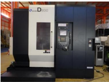
五軸加工機 牧野フライス
