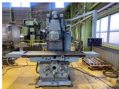
万能フライス 武田機械 TK-US5N 1989年製 テーブル2000×450 管理番号:H017369 置場:マシンプラザ本庄
