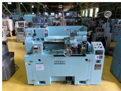
汎用旋盤 理研 RBL-51 2008年製 主軸貫通穴径31 心間500 管理番号:H017384 置場:マシンプラザ本庄
