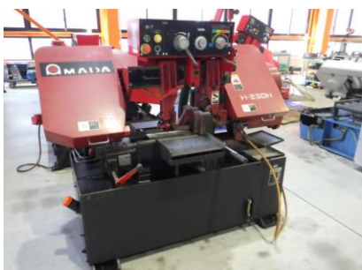
バンドソー アマダ H-250H 2003年製 切断能力:丸材250 角材250×300 管理番号:H017520 置場:マシンプラザ本庄
