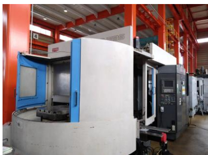
横型マシニングセンター 豊田工機 FH63S 1997年製 BT50 ATC40本 630角 管理番号:P008099 置場:東日本マシンブラザ
