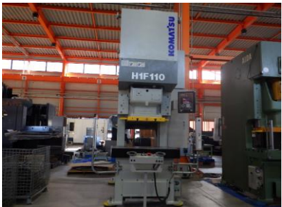
サーボプレス コマツ H1F110 2003年製 110t 光安付 ダイクッション付 管理番号:H017121 置場:マシンプラザ本庄
