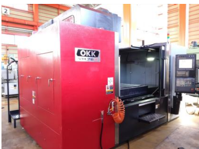
立型マシニングセンター OKK VM76R 2015年製 FANUC31i-MB BT50 管理番号:P008143 置場:東日本マシンプラザ
