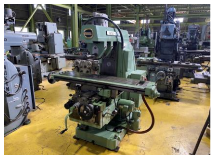
横フライス 平岡工業 2MF-P 1990年製 NT50 管理番号:H017145 置場:マシンプラザ本庄
