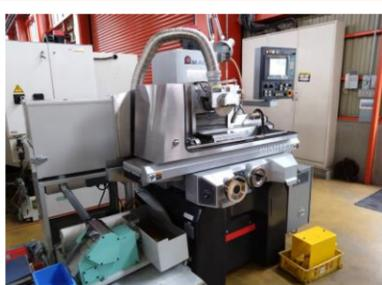
NC平面研削盤 アマダマシンツール
