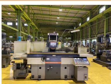
平面研削盤 日立精工
