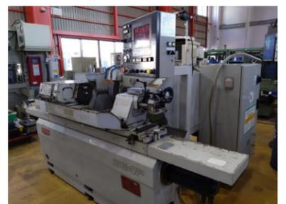
NC円筒研削盤 豊田工機
