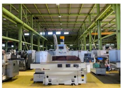
平面研削盤 アマダマシントール
