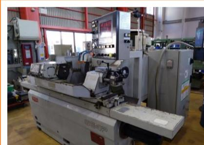
NC円筒研削盤 豊田工機
