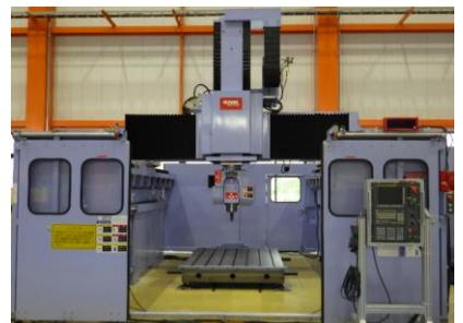
門型五軸加工機 新日本工機
