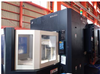
横型マシニングセンター 牧野フライス A66E-5XD 2006年製 Professional5 HSK-A63
