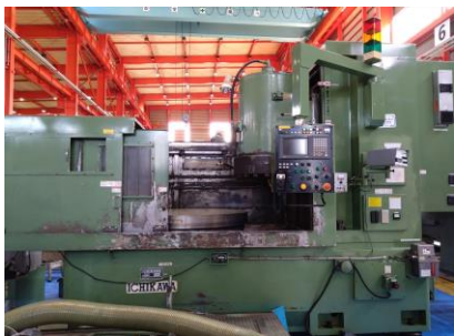
NCローター研削盤 市川製作所 ICB-1500NC 2002年製 チャックサイズφ1400
