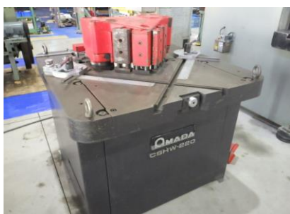
コーナーシャー アマダ CSHW-220 1987年製 最大加工板厚6mm
