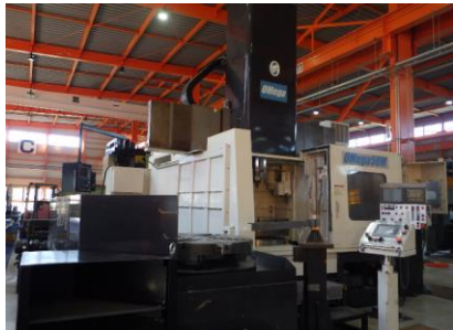
立型NC旋盤 オーエム OMEGA50M 2001年製 FANUC18i-T BT50 管理番号:H015709 置場:マシンプラザ本庄
