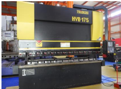
NCバンダー 東洋工機 HYB-17530 2004年製 175t テーブル長さ3000 ストローク長
