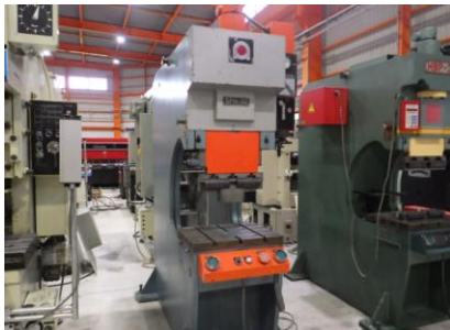
万能バンダー アマダ SPH-30C 1986年製 30t ストローク長さ100
