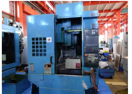
立型マシニングセンター 森精機 ACCUMILL4000 2011年製 MSX-805III(MELDAS) BT30 管理番号:P008130 置場:東日本マシンプラザ
