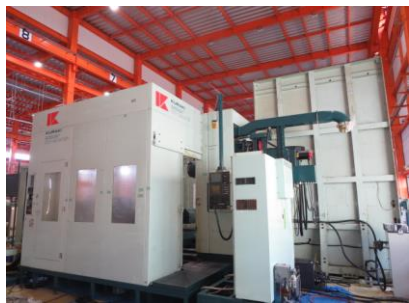
NC横中ぐり盤 倉敷機械 KBT-11M-ANT8P 2002年製 FANUC-16iMB BT50(2面拘束)
