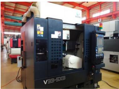
五軸加工機 牧野フライス
