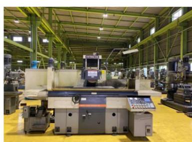
平面研削盤 日立精工
