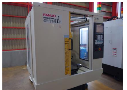
ドリリングセンター ファナック \alpha -T14iF 2008年製 FANUC31i-A5 BBT30 管理番号:P008258 置場:東日本マシンブラザ
