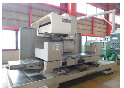
立型マシニングセンター 大隈豊和 MILLAC-852V 1997年製 OH-OSP-HMC BBT50 管理番号:P007140 置場:東日本マシンブラザ
