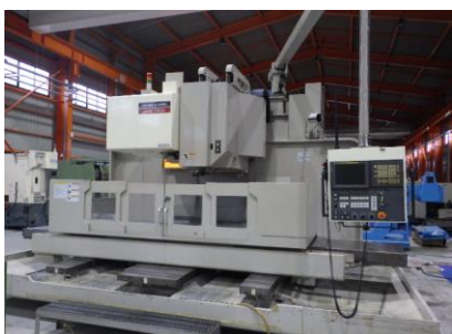
立型マシニングセンター 大隈豊和 MILLAC-1052V 2003年製 FANUC16i-M BT50 管理番号:H016030 置場:マシンブラザ本庄
