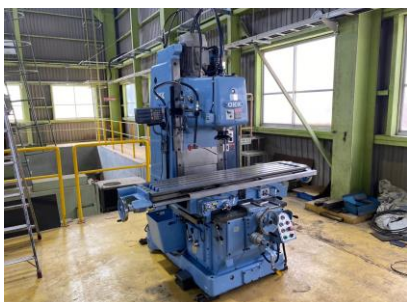
ベッド型フライス OKK MH-3V 1996年製 NT50 テーブルサイズ1650×380 管理番号:H017816 置場:マシンプラザ本庄
