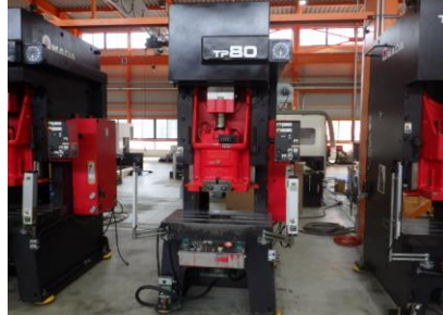
C型プレス アマダ TP-80C-X2 1993年製 80t ストローク数80 管理番号:H017729 置場:マシンプラザ本庄
