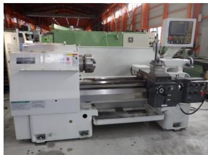
簡易型NC旋盤 滝沢 TAC-510 2008年製 FANUC20i-TB 管理番号:H017898 置場:マシンプラザ本庄
