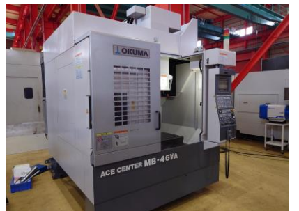
立型マシニングセンター オークマ MB-46VA 2003年製 OSP-E100M BT40 管理番号:P008254 置場:東日本マシンブラザ
