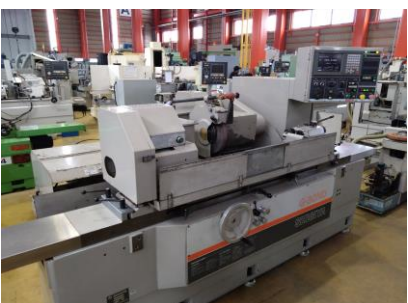
NC円筒研削盤 シギヤ精機 GP-30B-100ND 1995年製 テーブル上の振り300 心間1000 管理番号:P008119 置場:東日本マシンプラザ
