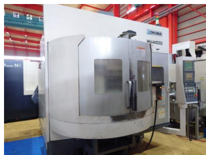
立型マシニングセンター オークマ MILLAC-468V 2007年製 FANUC3li-A BT50
