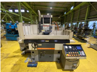
平面研削盤 日立精工 GHL-B506NS II 2007年製 チャックサイズ600×500 トレッサー 管理番号:H017370 置場:マシンプラザ本庄
