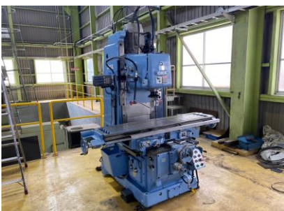
ベット型フライス OKK MH-3V 1996年製 NT50 テーブルサイズ1650×380 管理番号:H017816 置場:マシンプラザ本庄
