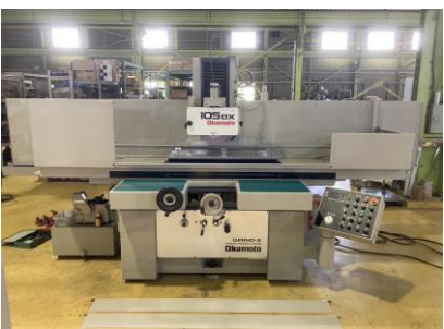
平面研削盤 岡本工作 PSG-105DX 1994年製 チャックサイズ1000×500 管理番号:H017861 置場:マシンプラザ本庄
