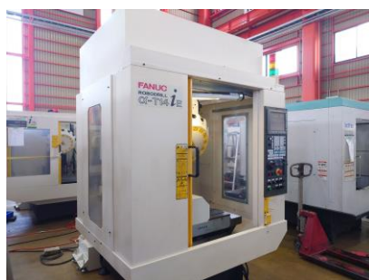
ドリリングセンター ファナック alpha-T14iE 2005年製 FANUC3li-A5 BBT30
