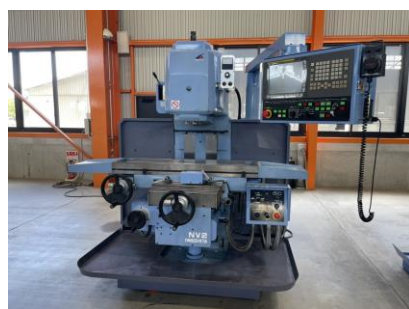
NC立フライス 岩下 NV2 2017年製 FANUC32i-B NT50
