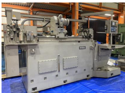
NCガンドリル ミロク MEG1000NC 2004年製 FANUC21i-MB 主軸回転数 管理番号:H018009 置場:マシンプラザ本庄
