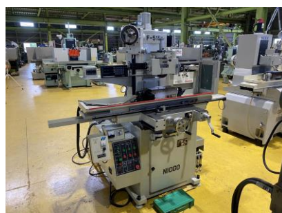
成形研削盤 ニッコー F-515HD III 2008年製 チャックサイズ315×110
