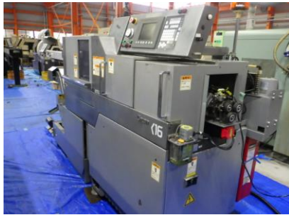
NC自動盤 シチズン K16-VP 2006年製 FANUC 管理番号:H017110 置場:マシンプラザ本庄
