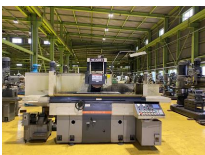
平面研削盤 日立精工 GHL-B510NSP II 2006年製 チャックサイズ1000×500
