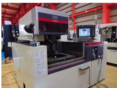
NCワイヤーカット 三菱電機 FA20PS ADVANCE 2008年製 W31FPSA-2 テーブルサイズ780×630
