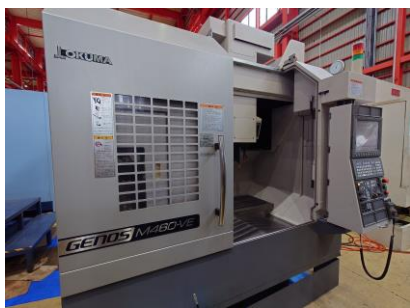
立型マシニングセンター オークマ GENOS M460-VE 2010年製 OSP-P200M BT40
