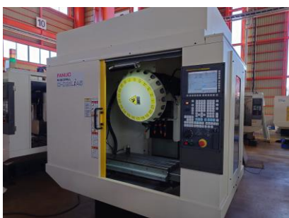
ドリリングセンター ファナック alpha-D21LiA5 2012.12年製 FANUC3li-B5 BBT30
