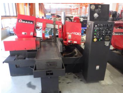
バンドソー アマダ HKA400 1999年製 切断能力: 丸φ320
