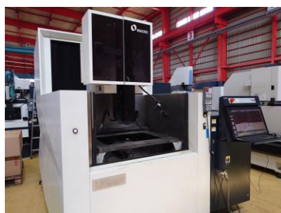
NCワイヤーカット 牧野フライス U6H.E.A.T 2014年製 Hyper i テーブルサイズ910×710
