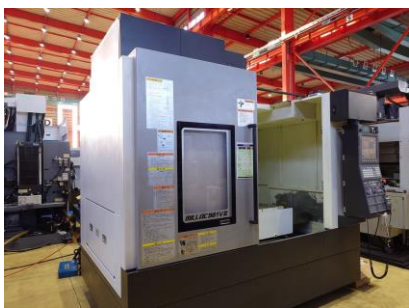
立型マシニングセンター オークマ MILLAC-561V II 2015年製 OSP-P300M BT50
