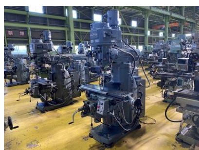
ラム型フライス 牧野フライス KVJP-55 1997年製 NT40 テーブルサイズ1100×250
