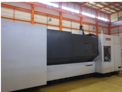
門型マシニングセンター 森精機 VS10000/40/3150 2006.8年製 MSX-501III(FANUC) BT40 管理番号:H015516 置場:マシンプラザ本庄
