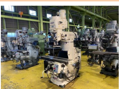
ラム型フライス 牧野フライス KVJP-55 1993年製 管理番号:H016571 置場:マシンプラザ本庄
