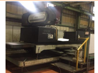
立型マシニングセンター OKK MCV-1260 2007.2年製 FANUC160is-MB BT50 管理番号:H016444 置場:マシンブラザ本庄
