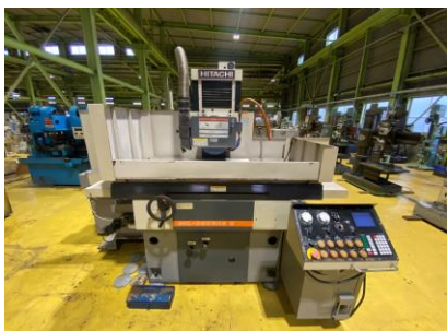
平面研削盤 日立精工 GHL-B506NS II 2007年製 チャックサイズ600×500 ドレスナー 管理番号:H017370 置場:マシンプラザ本庄
