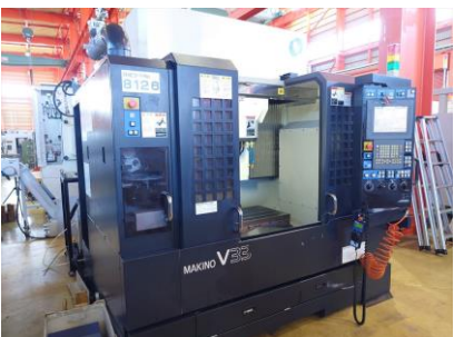
立型マシニングセンター 牧野フライス V33i 2008年製 Professional5 HSK-E50 管理番号:P008409 置場:東日本マシンブラザ
