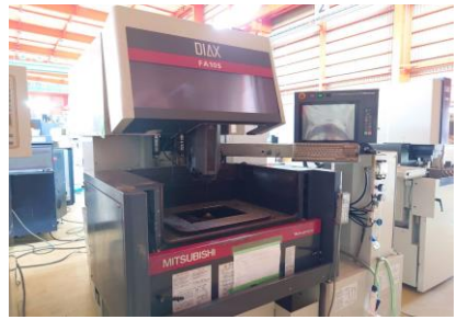
NCワイヤーカット 三菱電機 FA10SA 2007年製 テーブルサイズ590×514 管理番号:P008306 置場:東日本マシンプラザ
