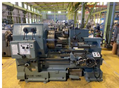
汎用旋盤 ブルーライン BL-1000H-320 1990年製 550Φ5爪スクロールチャック 心間750 管理番号:H017988 置場:マシンプラザ本庄
