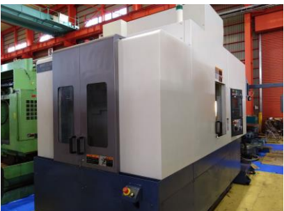
立型マシニングセンター 森精機 GV-503 1999年製 MSG-805(MELDAS) BT40 管理番号:P008077 置場:東日本マシンブラザ
