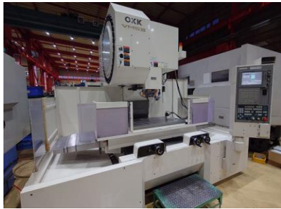
立型マシニングセンター OKK VM5III 2006年製 Neomatic635V BBT40 管理番号:P008408 置場:東日本マシンブラザ
