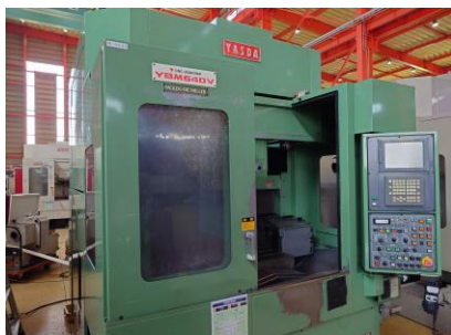
立型マシニングセンター 安田工業 YBM-640V 1998年製 FANUC-16iM BT40 管理番号:P008205 置場:東日本マシンブラザ
