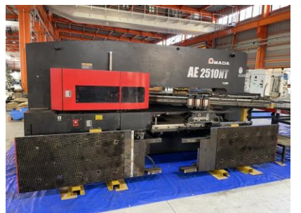
タレットパンチプレス アマダ AE2510NT 2017年製 能力20t ストローク長さ42 管理番号:H018138 置場:マシンプラザ本庄
