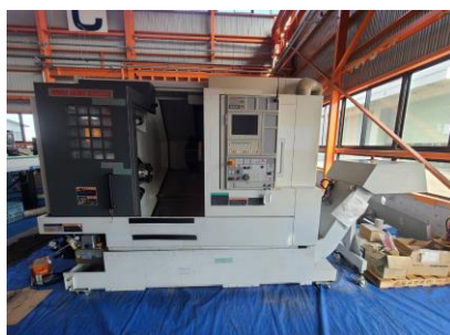
複合NC旋盤 森精機 NL2000Y/500 2013年製 M720BM 管理番号:H018144 置場:マシンブラザ本庄
