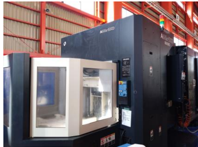
横型マシニングセンター 牧野フライス A66E-5XD 2006年製 Professional5 HSK-A63 管理番号:P007926 置場:東日本マシンプラザ
