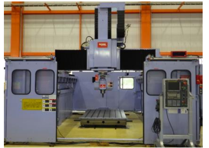
門型五軸加工機 新日本工機 MKS-2000/3100/5C 2008年製 FANUC31iA5 HSK-A63 管理番号:H014114 置場:マシンプラザ本庄
