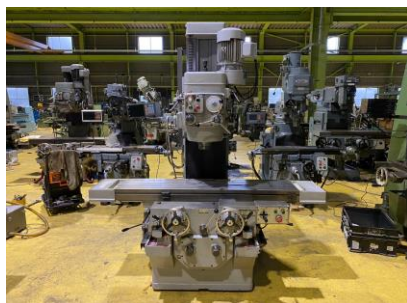
ベット型フライス 山崎技研 YZ-8C 1988年製 NT50 テーブルサイズ1500×350 管理番号:H018004 置場:マシンプラザ本庄
