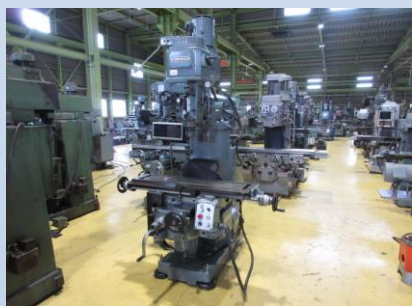
ラム型フライス 牧野フライス製作所 KVJP-55 1986年製 NT40 テーブルサイズ*1100×250 管理番号:H015261 置場:埼玉県本庄市
