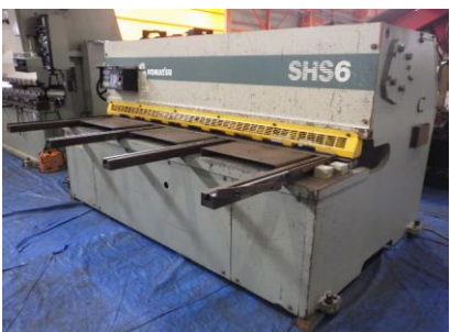
シャーリング コマツ SHS6×255 1996年製 能力6mm×2550mm オートバックゲージ 管理番号:H017700 置場:マシンプラザ本庄
