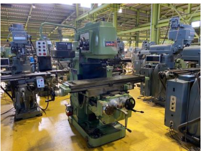
ひざ型フライス 大隈豊和 STM-2V 1988年製 NT50 テーブルサイズ1500×310 管理番号:H017915 置場:マシンプラザ本庄
