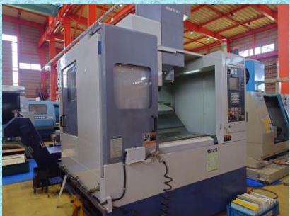
立型マシニングセンター 森精機 SV-500/40S 1997年製 MSD-516(FANUC) BBT40 管理番号:P008255 置場:東日本マシンプラザ
