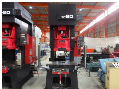
C型プレス アマダ TP-80 1993年製 80t ストローク数70spm 管理番号:H017688 置場:マシンプラザ本庄
