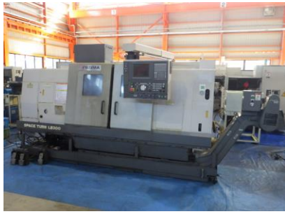
NC旋盤 オークマ LB300 2005年製 OSP-E100L 8吋3爪チャック 管理番号:H018081 置場:マシンプラザ本庄
