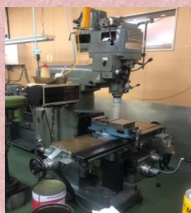
ラム型フライス 牧野フライス製作所 KSJP-55 1985年製 NT40 テーブルサイズ*1100×250 管理番号:G005363 置場:東京都八王子市
