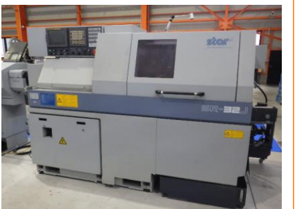
NC自動盤 スター精密 SR-32J 2011年製 FANUC18i-TB ローター・ガイドブッシュ 管理番号:H017821 置場:マシンプラザ本庄
