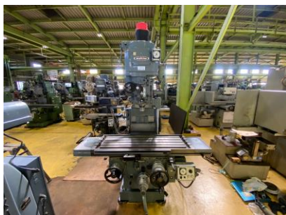
ラム型フライス 牧野フライス BVIIIJ-85 1989年製 NT40 テーブルサイズ1350×400 管理番号:H017931 置場:マシンプラザ本庄
