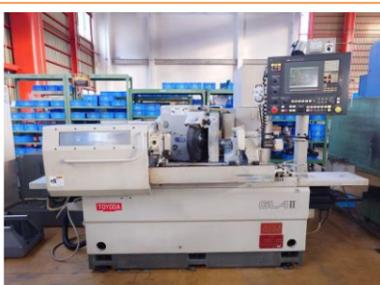
NCアンギュラ円筒研削盤 豊田工機
