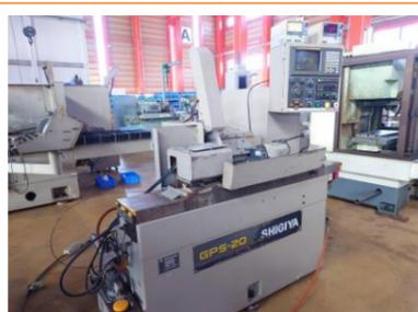
NC円筒研削盤 シギヤ精機
