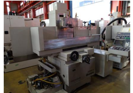
NC平面研削盤 岡本工作 PSG-52EXB 2005年製 チャックサイズ500×200 管理番号:P008041 置場:東日本マシンブラザ
