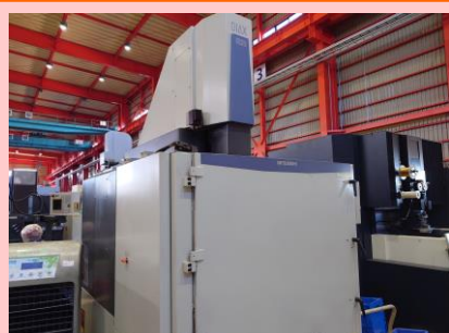
NC放電加工機 三菱電機 EA12M 2005年製 C21EA-2 テーブルサイズ700×500 管理番号:P006832 置場:東日本マシンプラザ
