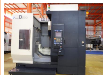
五軸加工機 牧野フライス D500 2008.9年製 Professional 5 HSK-A63 管理番号:H015918 置場:マシンブラザ本庄
