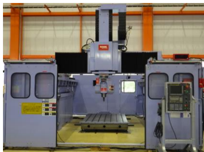
門型五軸加工機 新日本工機 MKS-2000/3100/5C 2008.3年製 FANUC31iA5 HSK-A63 管理番号:H014114 置場:マシンプラザ本庄
