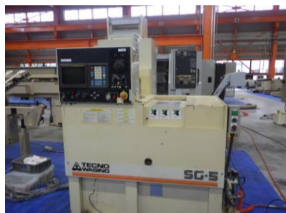
櫛刃型NC旋盤 テクノワシノ SG-5 1996.7年製 FANUC0-T コレットチャック 管理番号:H016430 置場:マシンプラザ本庄
