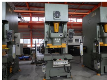
C型プレス アイダ NC1-110(2) 1991年製 110t ダイクッション付 管理番号:H016448 置場:マシンプラザ本庄
