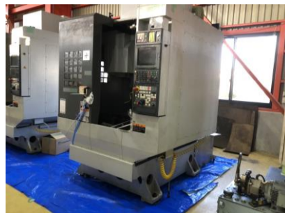
立型マシニングセンター 森精機 ACCUMILL4000 2005年製 MSX-805(MELDAS) BT30 管理番号:P007815 置場:東日本マシンプラザ
