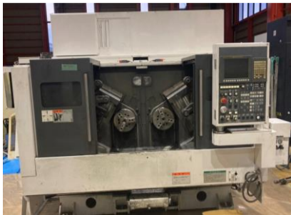
NC旋盤 滝沢 TT-2600 2016年製 FANUC0i-TD 平行2スピンドル
