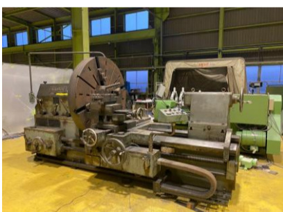
正面旋盤 藤井精機 60-6FLH-15 1983年製 1500 φ4爪単動チャック 心間1500
